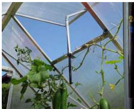
Автоматический открыватель окон Spigo - с термометром.- Нержавеющая сталь. Подходит для теплиц со секлом.поддерживает температуру воздуха в диапазоне от 16°C до 25°C Открывает до 45 см. Вес поднимаемого окна до 7 кг.
